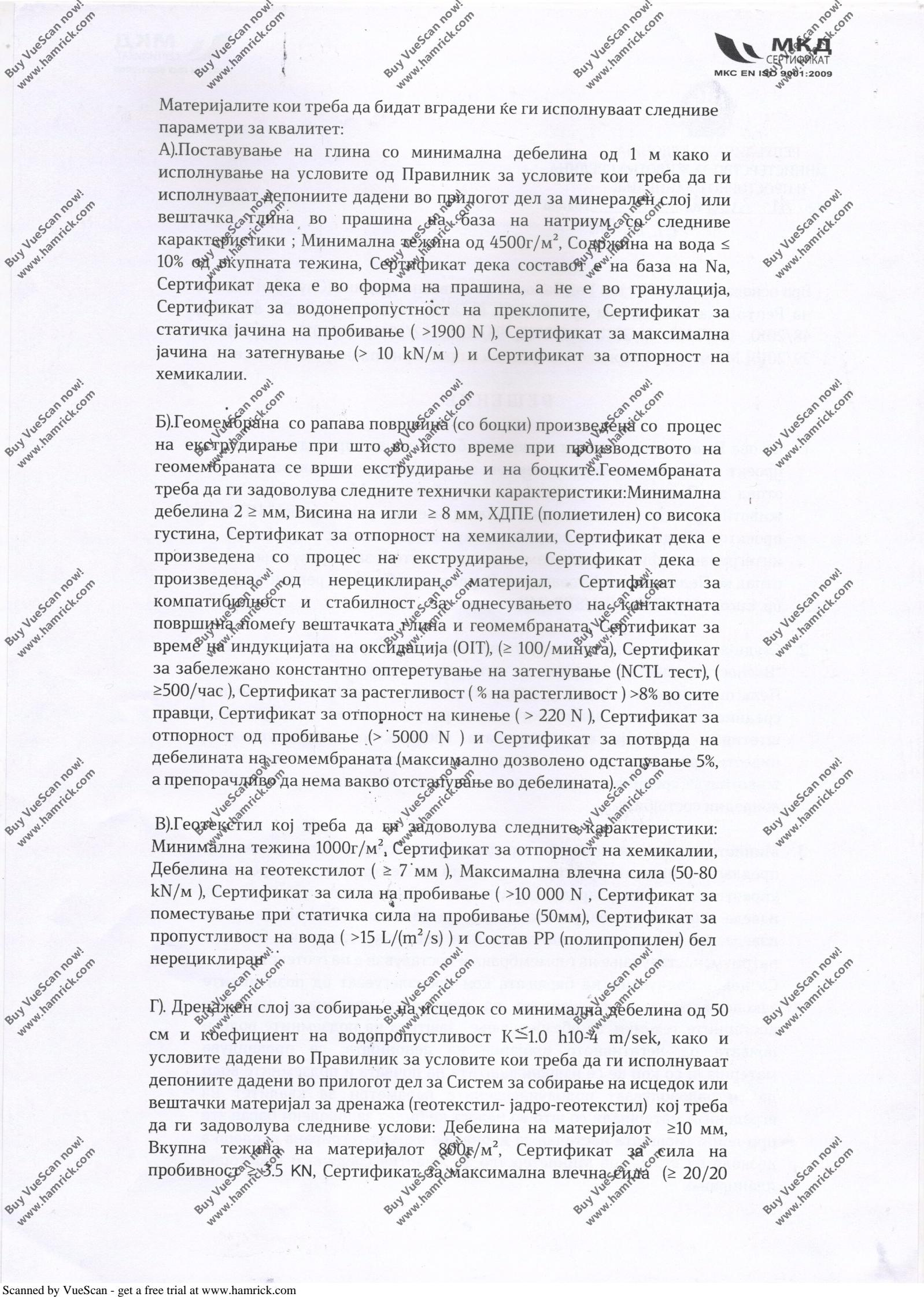
kN/m), Сертификат за растегливост (% на растегливост)  $\geq 45\%$ , Состав на слојот од геотекстилот PP (полипропилен) бел нерециклиран, Минимална тежина  $\geq 150\text{g}/\text{m}^2$ , Дебелина на слојот од геотекстилот  $\geq 2\text{mm}$ , Пропустливост на вода на геотекстилот  $\geq 90\text{ l}/\text{cm}^2$ , состав на јадрото полипропилен црн
